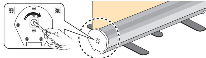
8 吊り部分を引っ張りメディアを巻き取ってください。吊り部分を引っ張っても全く巻き取れない場合は巻き取りパイプを直接手で前後に回転させてみてください。
